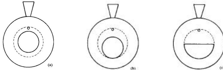
Figura 19 - Placas de orifício concêntrica (a), excêntrica (b) e segmentada (c).
