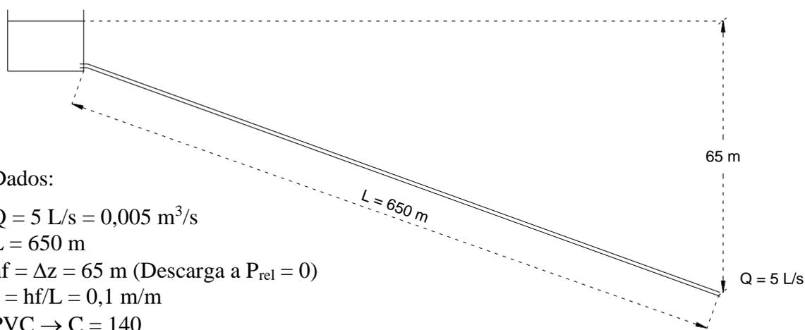
a) Determine o diâmetro de um tubo de PVC para as condições do esquema acima:
